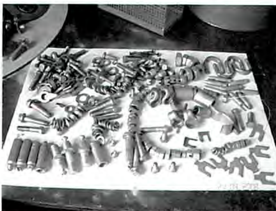
Gestraald en klaar voor verzinken. Dit is slechts een deel
