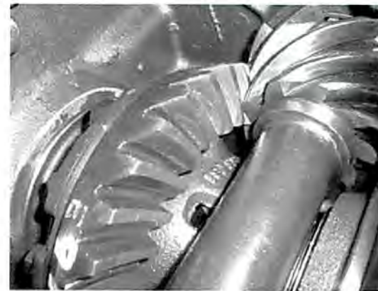
Het correcte slijtagebeeld van het rondsel, we laten het zo
