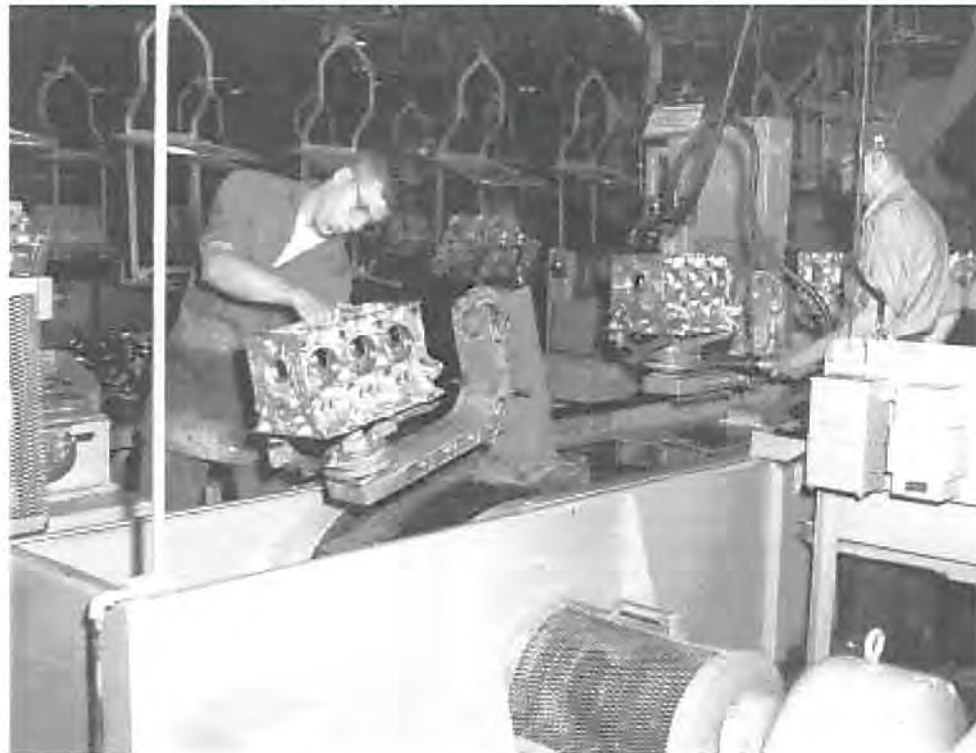
De blokken komen hier uit een machine waar het de diverse boringen heeft ondergaan.
