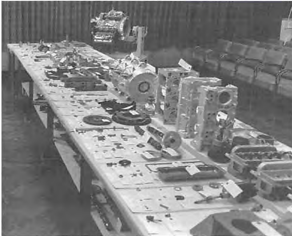
Veelvuldig werden er blokken uitelkaar gehaald en op slijtage gecontroleerd en besproken. Dit gedomenteerd blok ligt in een vergaderzaal.
