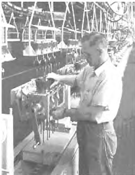
Cilinders met zuigers erin hangen in het rek en worden hier op het blok gebouwd.
