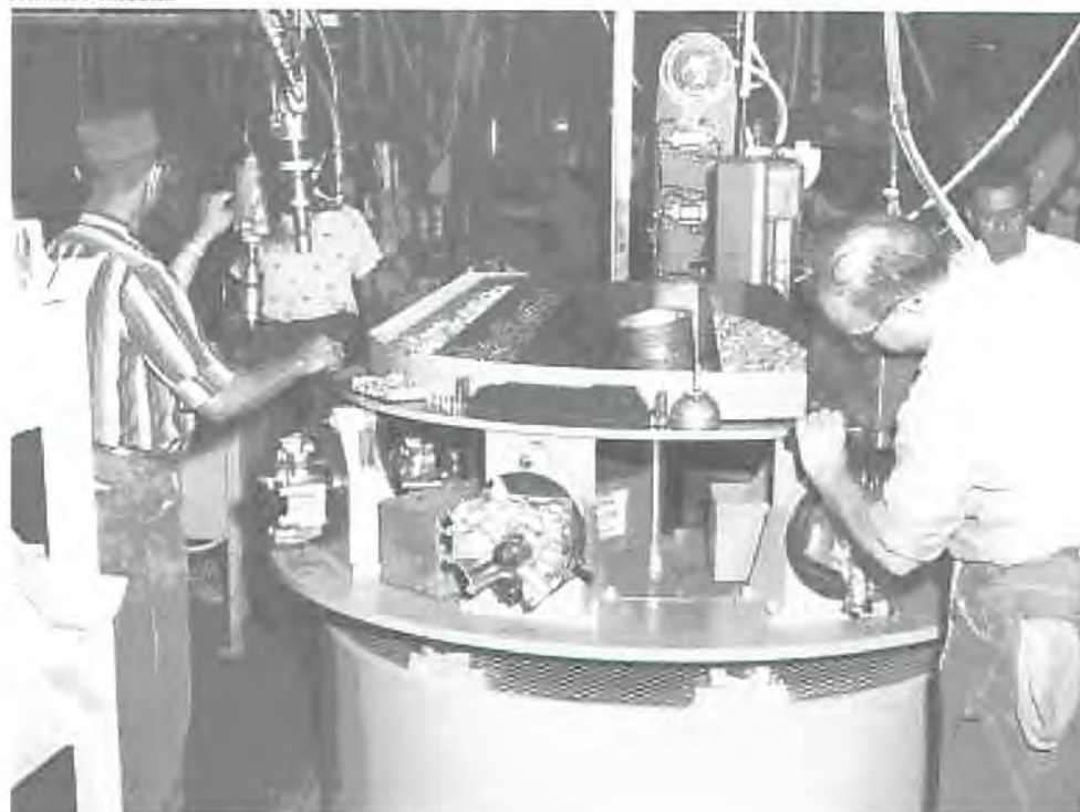
Cilinders met zuigers erin hangen in het rek en worden hier op het blok gebouwd.
