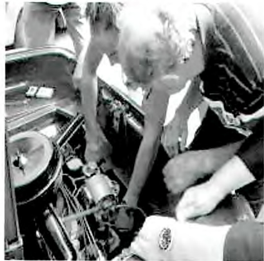
Het verwisselen van de V-snaar in Willem Boon's '62 cabriolet ging niet zonder enig commentaar.
