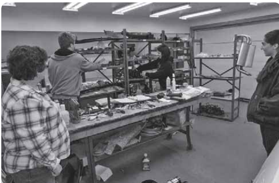
12 schappen waar alle onderdelen op liggen. Gesorteerd per groep zodat de medewerkers weten waar de andere groep gebleven is. Alle bouten en moeren worden gemarkeerd zodat iedereen weet welke al vast zitten.
