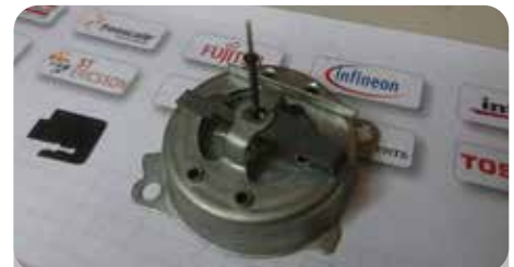
Snelheidsmeter met afgenomen wijzer
