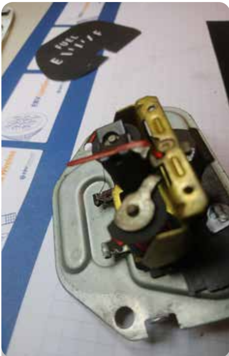
Benzinometer met verbogen spoelkernen
