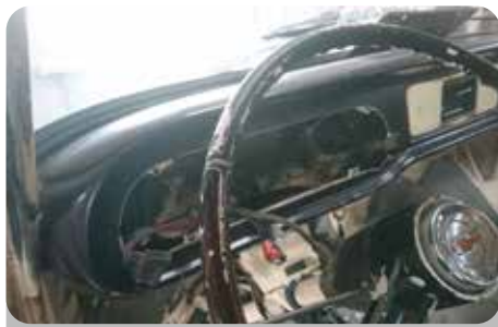
Instrumentenpaneel uit dashboard
