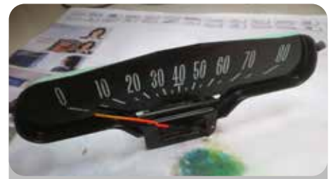
Snelheidsmeter uit instrumentenpaneel
