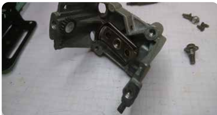
Frame snelheidsmeter met vastgelopen tandwiel
