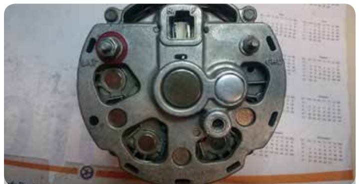
+ diodes in het binnenframe, - diodes in de buitenschaal, condensator naast het lager, borstelunit achter de R en F aansluitingen, borstel borgpennetje boven het lager.
