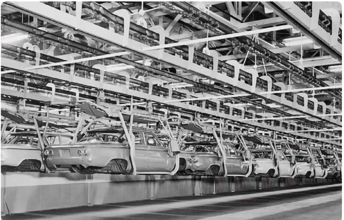
Deze foto van de Corvair carrosserie transport lijn was genomen op 29 oktober 1959 bij de Willow Run fabriek. De bijna kant en klare carrosserieën gingen via deze manier naar de laatste fase van de fabriek, de eind montage.
