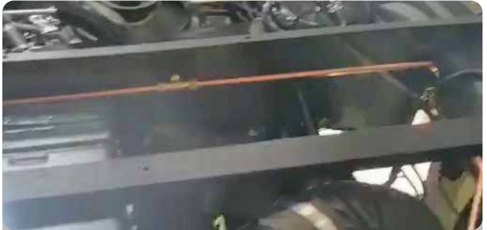
Oversteek leiding achter firewall
