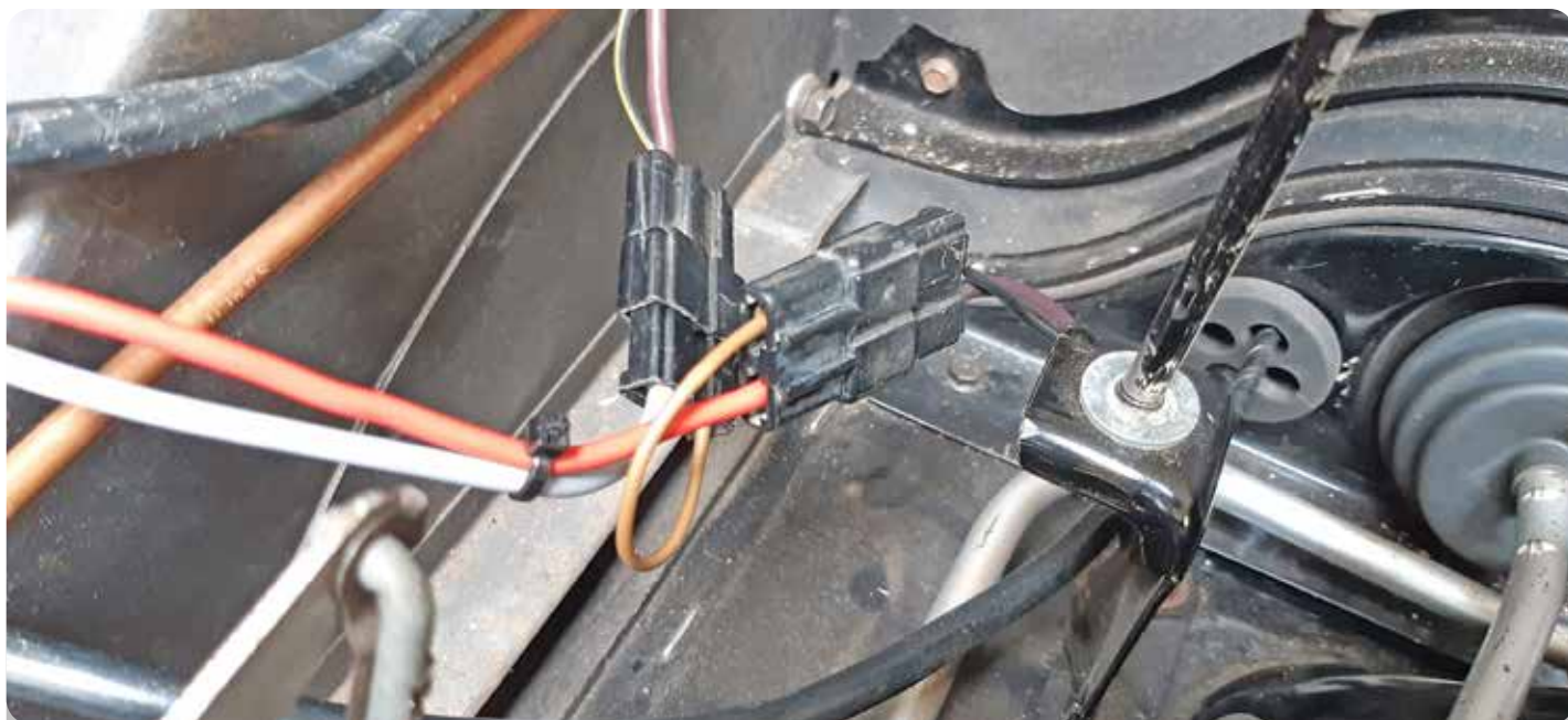
Paarse draad startcommando via relais naar startsolenoïde
