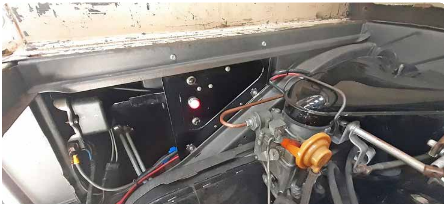
Contactschakelaar, olie/temp lamp en startdrukknop
