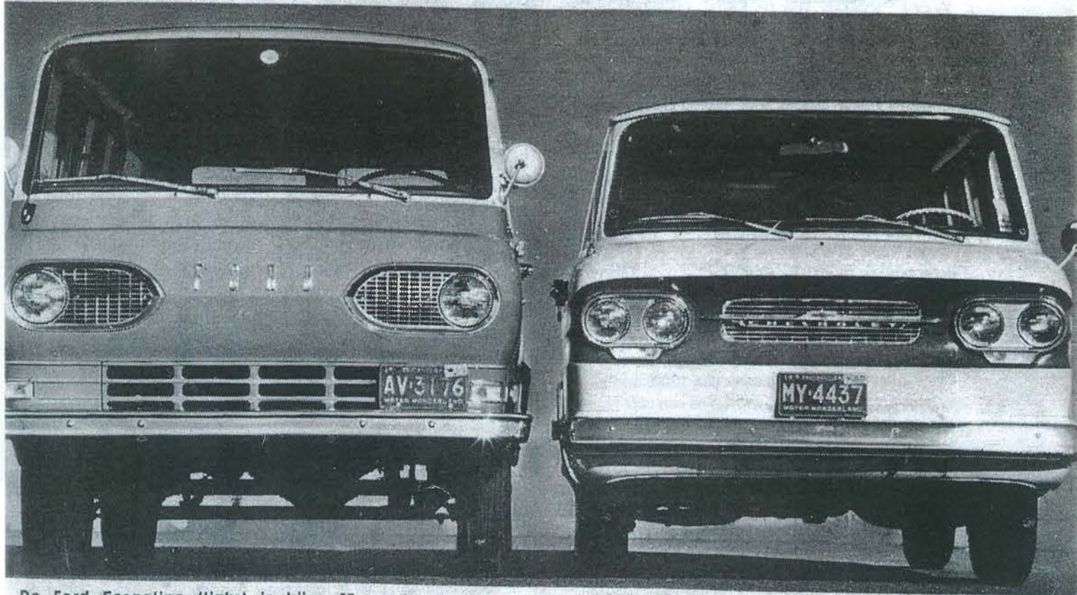
De Ford Econoline (links) is bijna 25 cm hoger dan Chevrolets Greenbrier en zo op het eerste gezicht meent men dat hij ook een grotere grondspeling heeft. De foto verraadt echter dat dit niet het geval is: beide modellen hebben 18 cm vrije ruimte tussen wegdek en onderzijde van de wagen.
