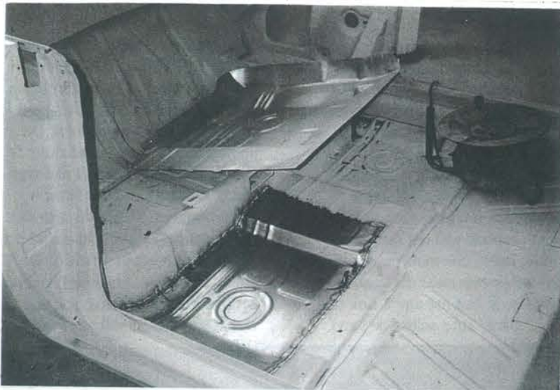
Nieuwe vloerdelen van Clark's. Alles wat twijfelachtig was werd vervangen. De overgangen worden geslepen en vertind. Plamuur-gebruik is daarbij minimaal.
