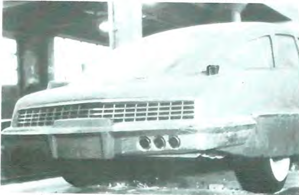
De achterkant van het 2 e model: de achterrauit stond te hoog en de uitlaatpijpen werden in de bumper geplaatst.
