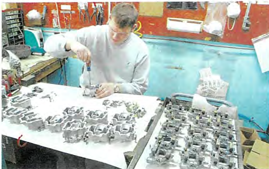
Carburateurs worden geglaspareld en volledig met nieuwe onderdelen opgebouwd.
