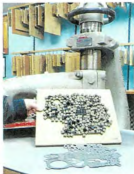
Ingewikkeld stansmes voor PG pakking
