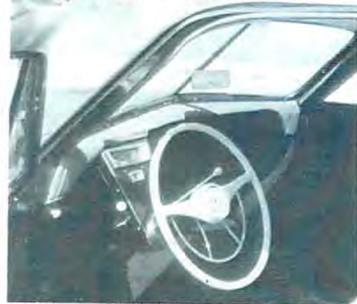
Het karige vooroorlogse Studebaker instrumentenpaneeltje...
