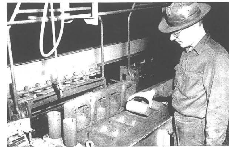
De gevinde gietijzeren cilinders begonnen hun leven in zandmallen
