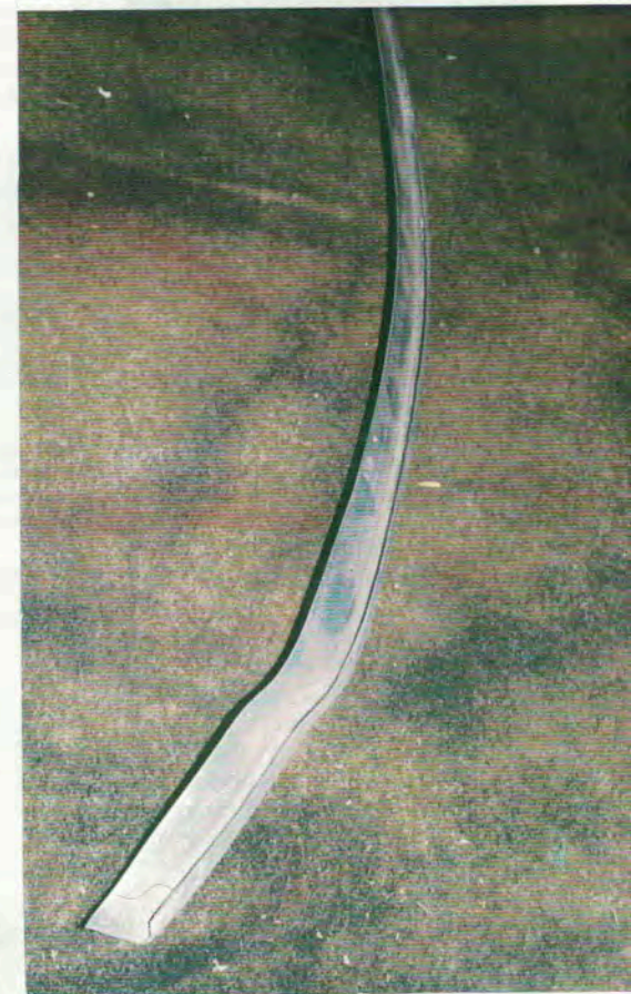
De strip nog ongebogen. Let ook op de apart bewerkte onderkant die moet aansluiten op de naad van het scherm
