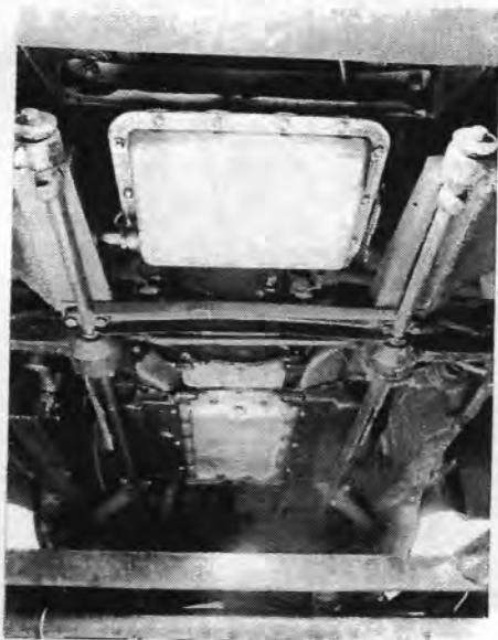
Onderkant: Vóór de automaat, daar achter de motor. De torsiestaven zijn links en rechts te zien.
