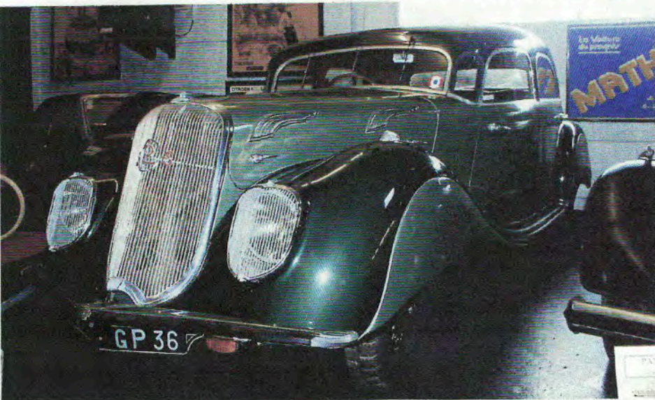
De vooroorlogse rechtsgestuurde Panhard & Levasseur. Motor zonder kleppen, en dubbele A-stijl.
