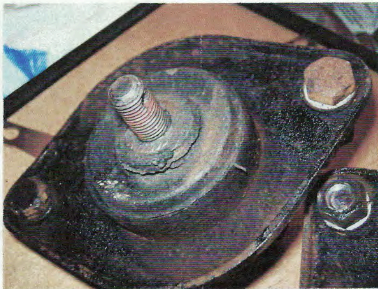
'Transmission mount' met scheurtjes in het rubber.
