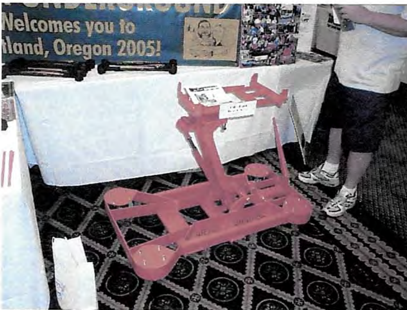
Hieronder een speciaal door/voor GM ontwikkelde krik die bedoeld was om de motor van een Corvair uit een wagen te laten zakken.
